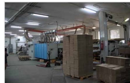
Ротационная линия SRPACK с 4-х цветной печатью форматом 1200X2600
