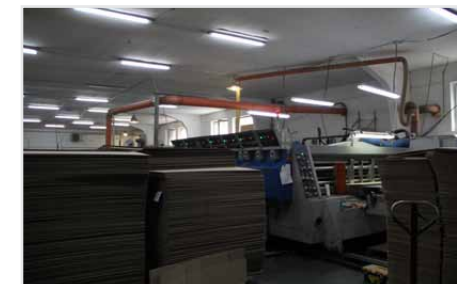
Ротационная линия SRPACK со слоттером, фальцесклеивкой и 3-цветной печатью форматом 1200X2600
